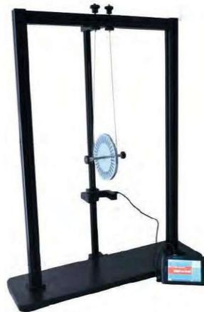
**REME21-GDX ДИСК МАКСВЕЛЛА ВЕРСИЯ GO DIRECT (БЕСПРОВОДНАЯ ПЕРЕДАЧА ДАННЫХ)**
