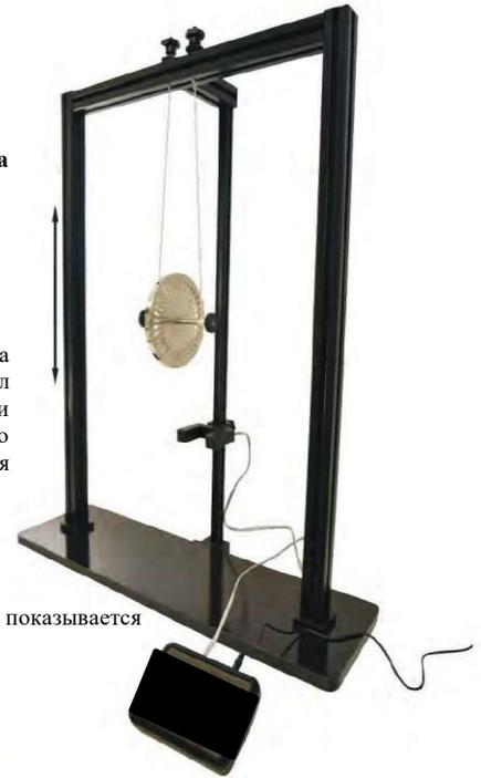
Период диска Максвелла показывается на экране таймера
