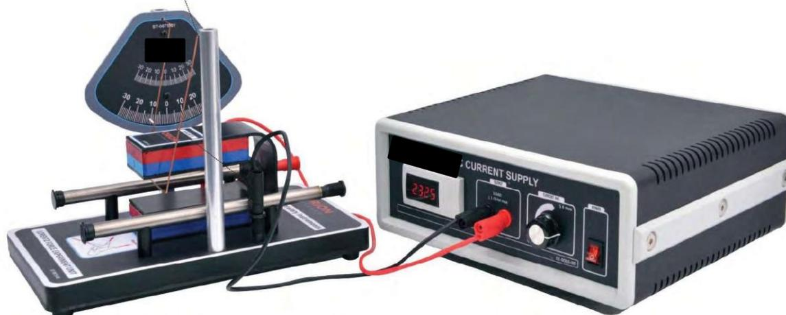
Ток пропускается через провод, помещенный в однородное магнитное поле, появляется магнитная сила на проводе. В широком диапазоне различных токов измеряется угол наклона провода.
