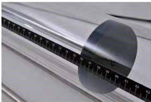
Поршень перемещается медленно, чтобы получить максимальную акустическую амплитуду (резонанс). Расстояние между двумя соседними пучностями измеряется по линейке на резонансной трубке. Таким образом, вычисляется акустическая длина волны внутри трубки. Сигнал, исходящий от генератора, можно обнаружить с помощью микрофона.
