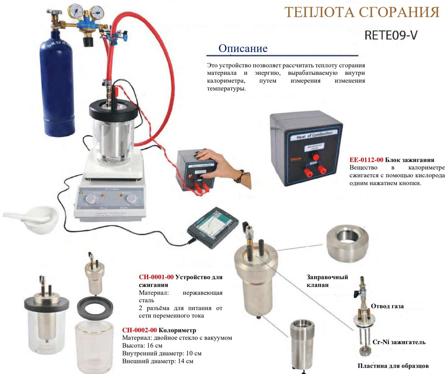
**CH-0001-00** Устройство для сжигания
