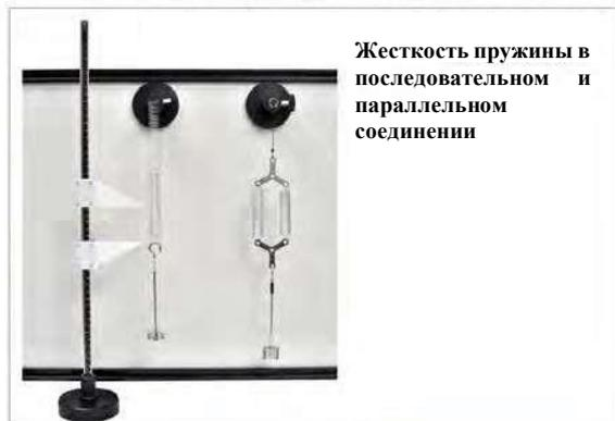
Жесткость пружины в последовательном и параллельном соединении
