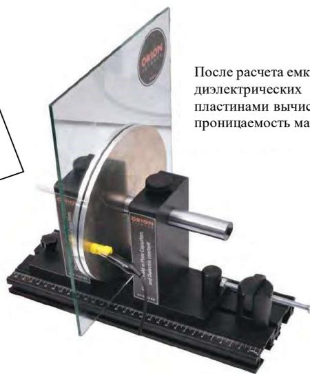
После расчета емкости, путем размещения диэлектрических материалов между пластинами вычисляется диэлектрическая проницаемость материала.
