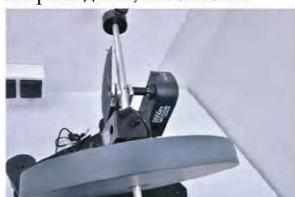
Угловая скорость нутации ( $\omega_N$ ) гироскопа измеряется с помощью третьего датчика Vernier
