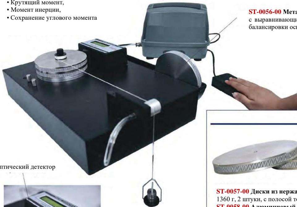
**ST-0056-00** Металлическое основание с выравнивающими винтами (3 шт.) для балансировки основания
