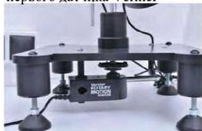
Угловая скорость прецессии ( $\omega_P$ ) гироскопа измеряется с помощью второго датчика Vernier
