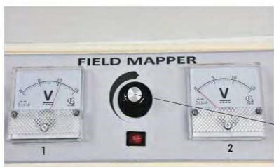
Плавная регулировка выходного напряжения
