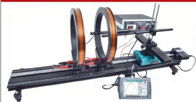
График положения и магнитного поля, автоматически построенный LabQuest "3"
