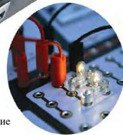
Параллельное соединение лампочек
